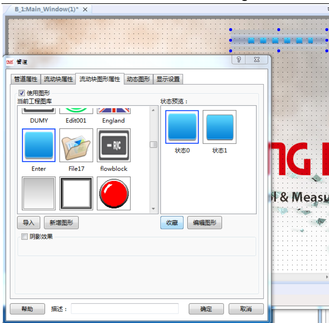
(4) 动态图形-这里可以设置管道的动态显示
